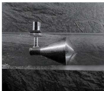
3 - Il V-Cone® in presenza di condensato
