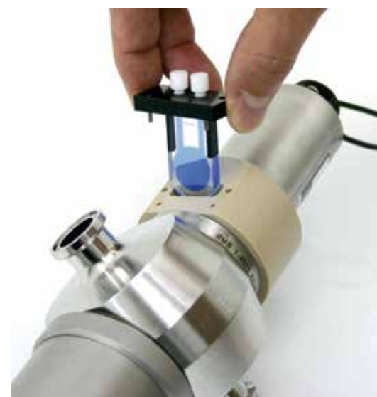
SI PUÒ ESEGUIRE LA VALIDAZIONE DELLA CATENA DI ANALISI DIRETTAMENTE IN SITU
