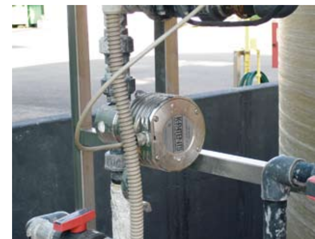
INSTALLAZIONE PA-33 per misura di solfato di ammonio in discarica
