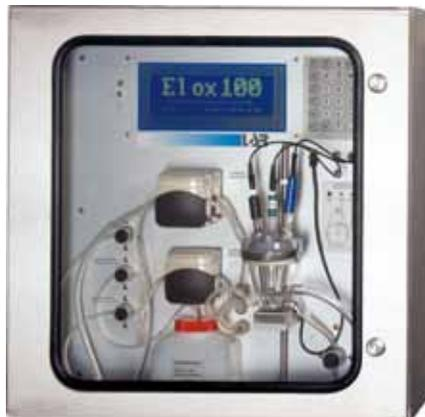
neamente eliminando la necessità e i costi della filtrazione classica. Si noti che a differenza di sistemi basati sulla fotometria nell'Elox100 la reazione di ossidazione avviene realmente e non essendo influenzata da agenti esterni, come ad esempio il colore del campione o la sua torbidità, presenta una correlazione eccezionale con l'analisi standard via bicromato.
