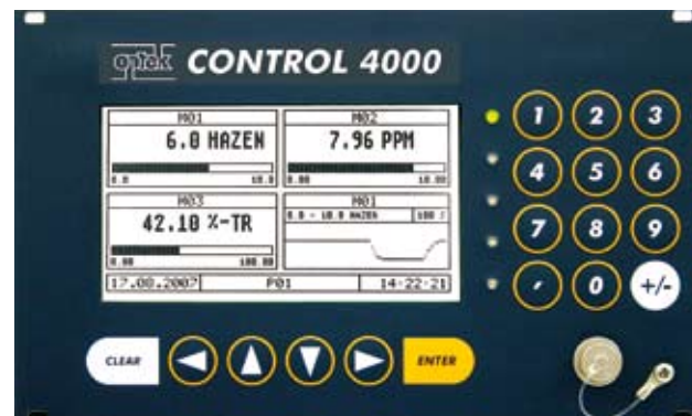
3 - Convertitore C-4000 multicanale con compensazione in T e P
