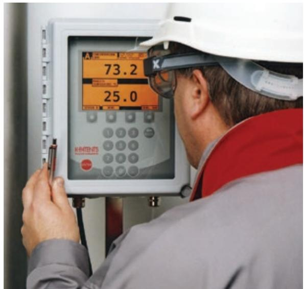
PROCESS REFRACTOMETER PR-23-W/M
